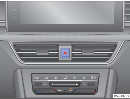
图 44 在中控台上部分中：危险警告灯开关
